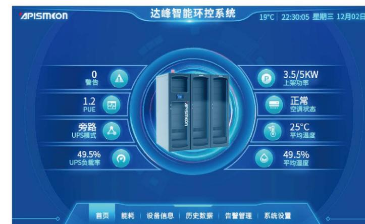
用于展示微型数据中心设备的告警和故障基本情况, 包括 UPS、配电、制冷、机柜、消防、IT 等多个子系统设备分布情况以及在子系统维度的设备、告警和故障数量信息。
